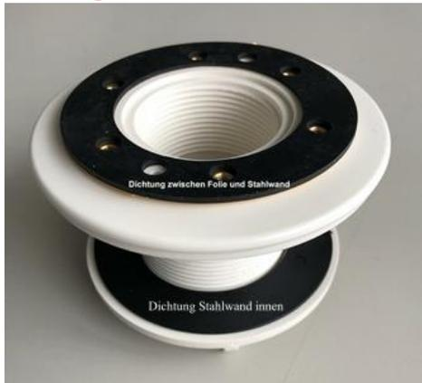
conZero Rundpool Komplettsets sind mit Multiflow Düsen als Wanddurchführung für die Scheinwerfer und auch für den Wassereinlass konfiguriert. Im Gegensatz zu den „normalen“ Einlaufdüsen, müssen diese vor dem Einhängen der Folie montiert werden. Später wird die Folie dann an dieser Stelle ausgeschnitten und der Innenflansch wird von innen mit dem bereits montierten Teil der Multiflowdüse verschraubt.
